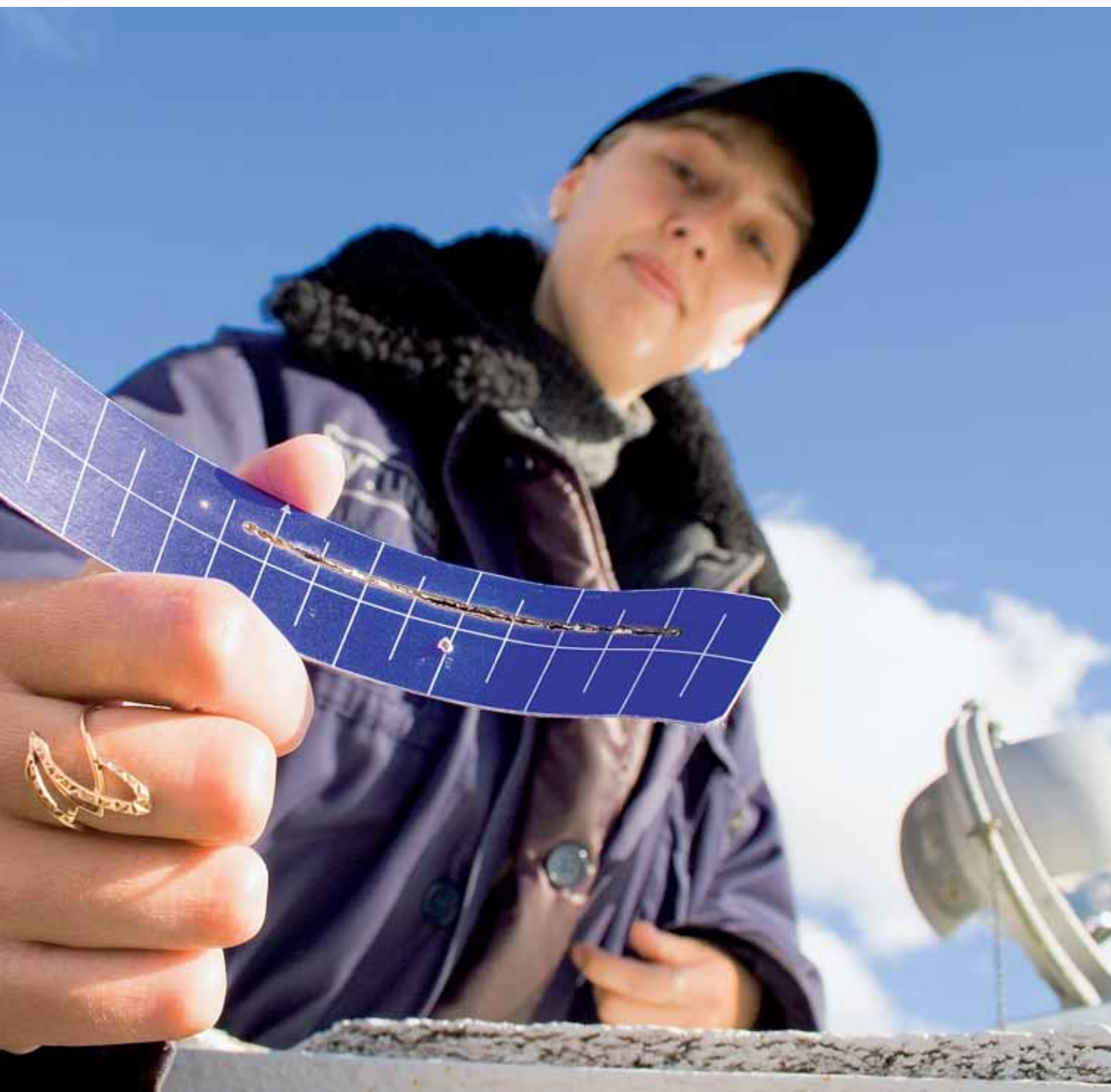
Техник-метеоролог Вера Корзинникова: так работает гелиограф
