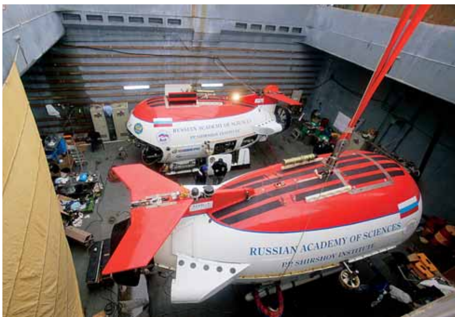
Глубоководные обитаемые аппараты серии «Мир» в готовности к штурму арктической глубины
